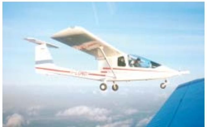
SkyArrow, le plus petit avion de recherche au monde, mesure les flux de CO<sub>2</sub> et de vapeur d'eau.
