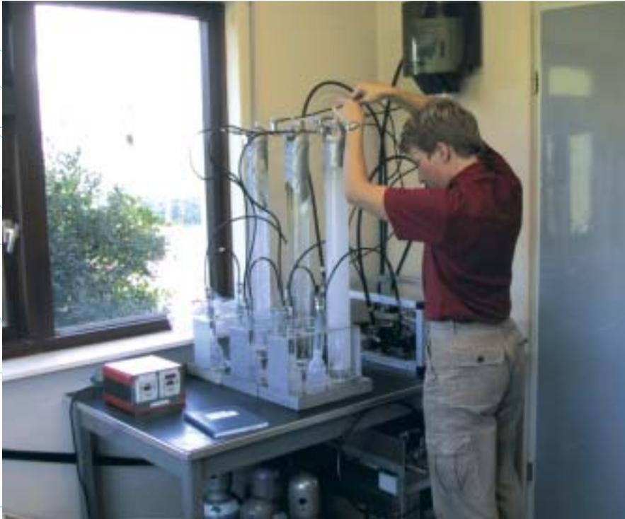
*Dans la station de surveillance atmosphérique de Lutjeward (Mer du Nord), des échantillons de CO<sub>2</sub> sont prélevés deux fois par semaine par absorption du CO<sub>2</sub> dans de l'hydroxyde de sodium*
